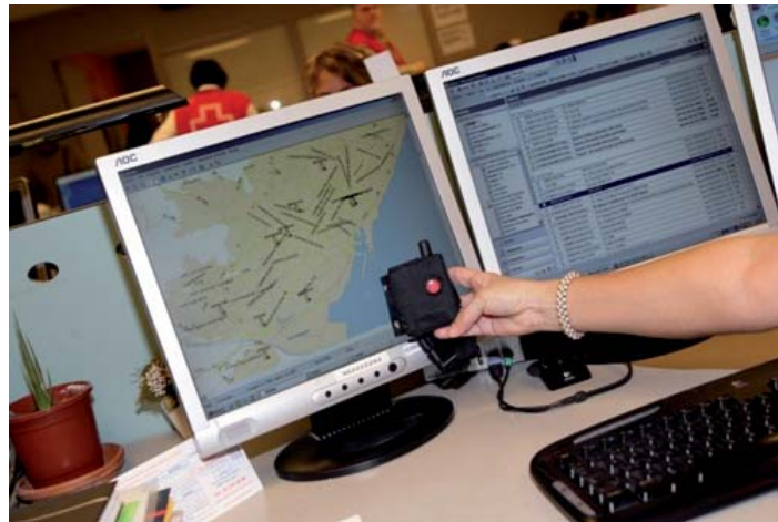
El SIMAP consta d'un dispositiu mòbil que el malalt porta a sobre de manera que en qualsevol moment se'l pot localitzar
