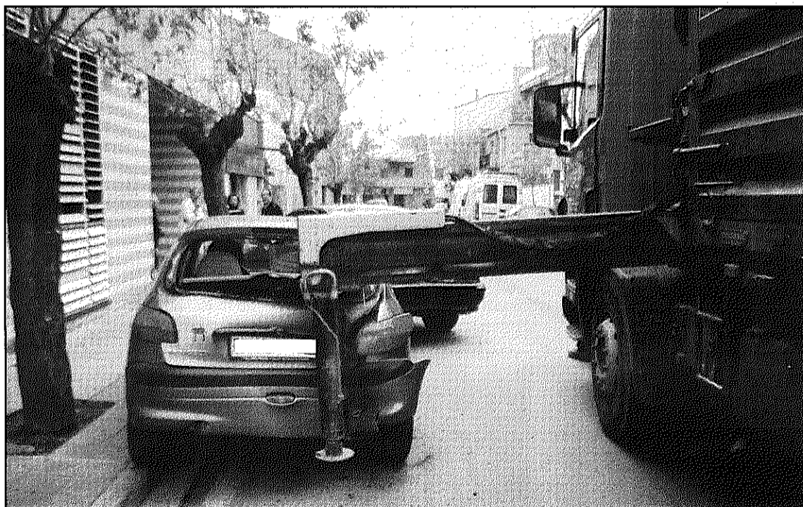
Una imatge de l'accident provocat per la pota hidràulica d'un camió en marxa (POLICIA LOCAL)
